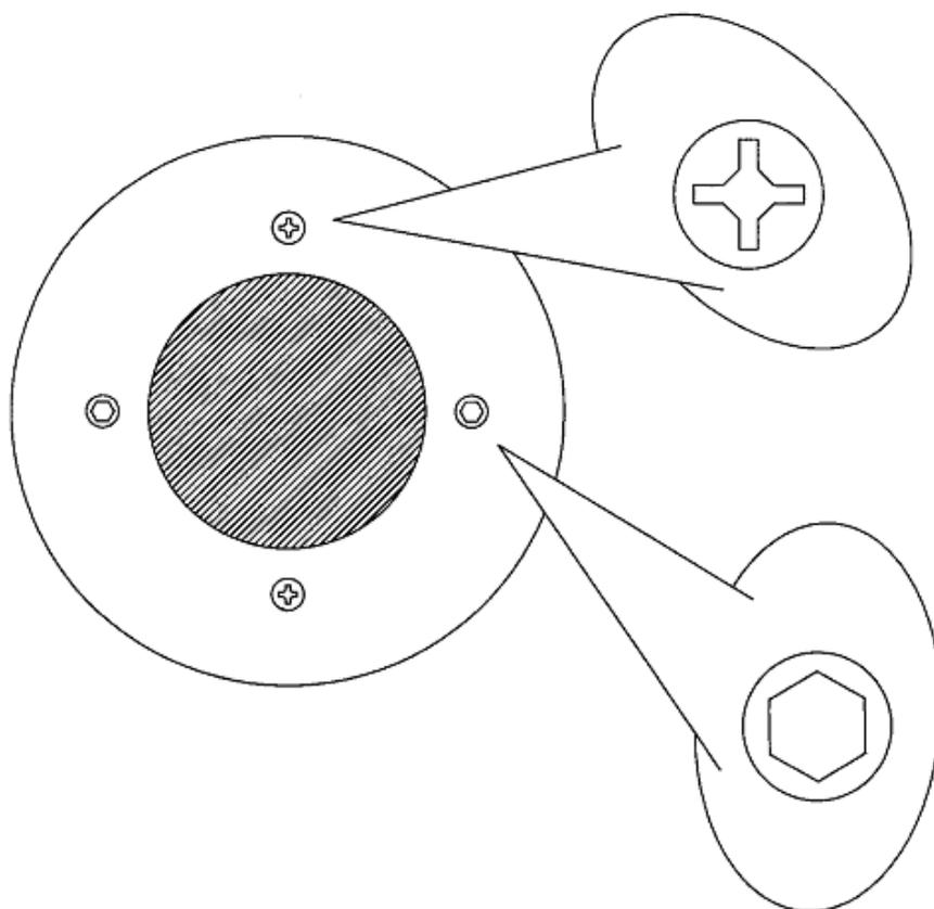
Pour enlever le spot, dévisser les deux vis avec tête à taille en croix. Après, pour démonter la bague en acier, dévisser les deux vis avec tête en hexagone encaissé. Dans le remontage, suivre la procédure contraire, et s'assurer d'avoir nettoyé et positionné correctement les différents composants (garniture, verre, dés, bague et vis). Serrer fortement les vis avec outil APTE.
