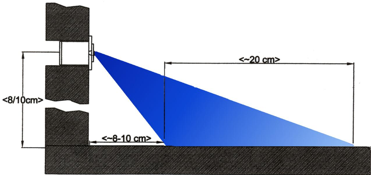
**ATTENZIONE! IL FASCIO DI LUCE PUO' CAMBIARE IN BASE AL MODELLO DI FARO E ALLA LENTE INCORPORATA NEL MEDESIMO.**
